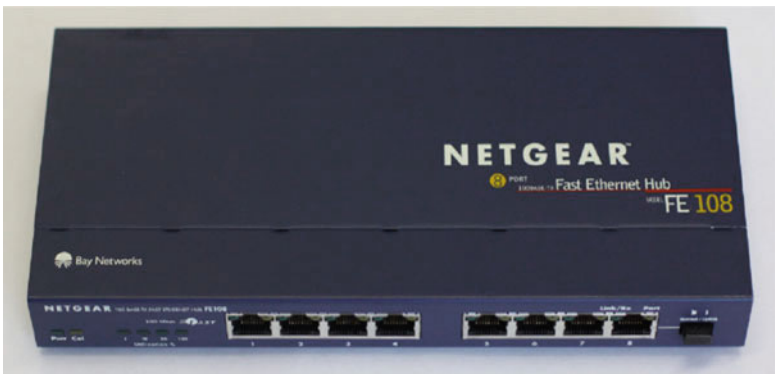
Abb. 5.17 Multiport-Repeater (Hub) mit 8 Schnittstellen (Ports)
