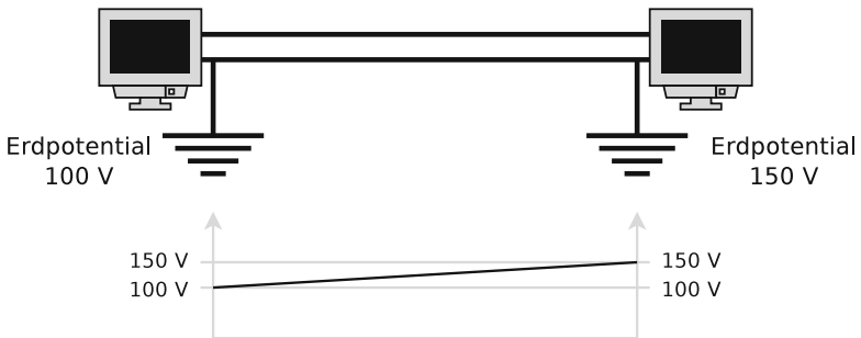
Abb. 5.15 Schirmung zwischen Gebäuden führt zu Antennenwirkung
