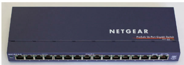
Abb. 6.1 Layer-2-Switch mit 16 Schnittstellen (Ports)
