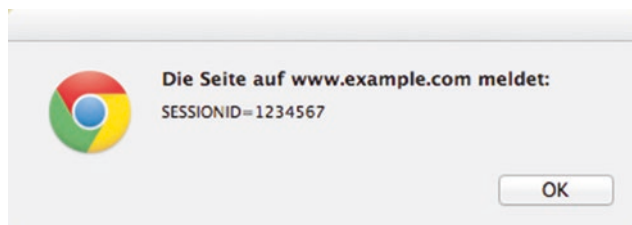
Abb. 2.17 Erfolgreiches XSS (JavaScript-Alert wird angezeigt)
