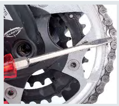
Bei mehr als 3 Millimeter „Luft“ sollte man die Kette austauschen.
