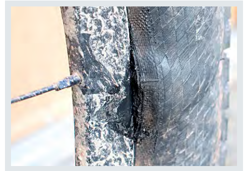
Seitenflanke des Reifens aufgerissen
