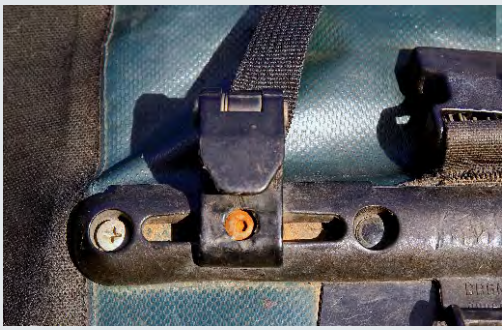
Vernietung an Fahrradtasche mit Schraube gerettet
