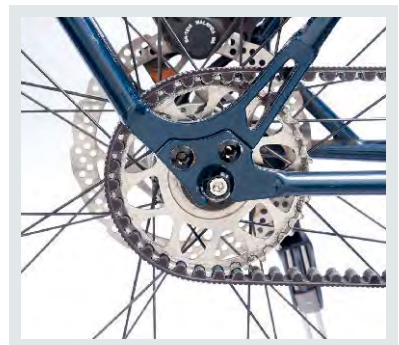
Drei unterschiedliche Rahmenschlösser und -spanner bei Fahrrädern für den Riemenantrieb
