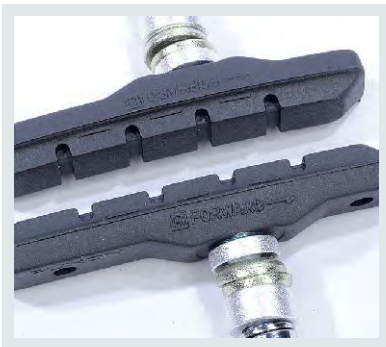
Anzeige der Laufrichtung auf Bremsschuhen beachten.
