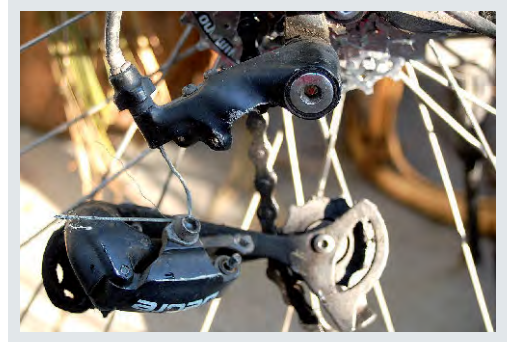
Schaltwerk abgerissen: Notfalls geht's ohne.
