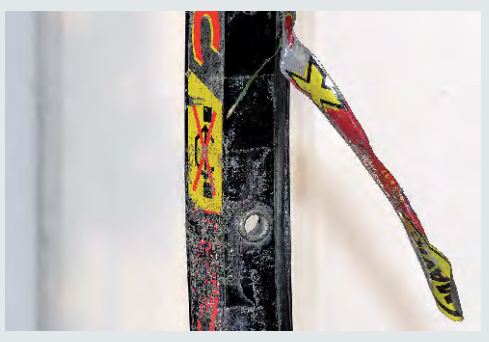
Felge eingerissen. Gewebeklebeband stabilisiert.
