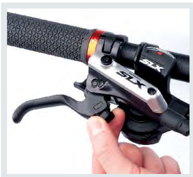
Hier stellt man den Abstand zwischen Lenker und Bremshebel ein.
