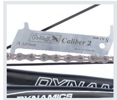
Neuwertige Kette mit Verschleißanzeige von Rohloff
