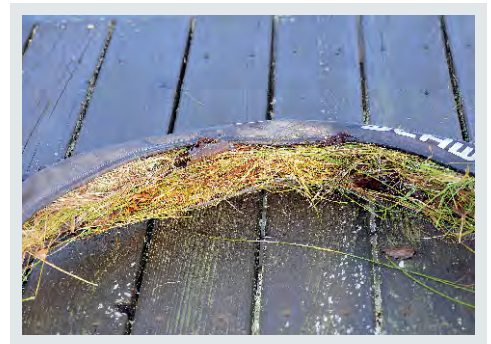
Schlauchersatz: Reifen ausstopfen
