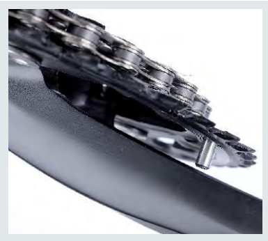
Kettennietfang am größten Kettenblatt
