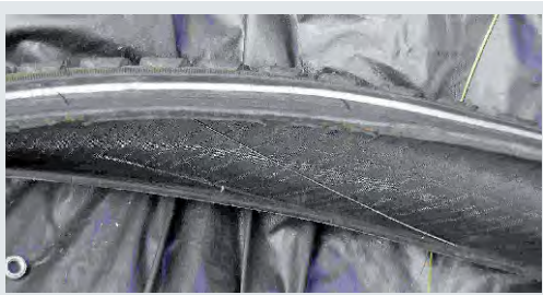
Drahtbruch beim Reifen
