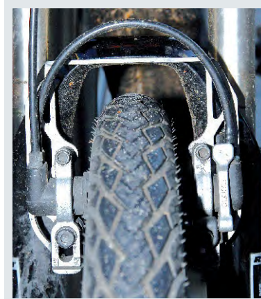
Die helle Metallbrücke an der Bremse ist ein Booster.
