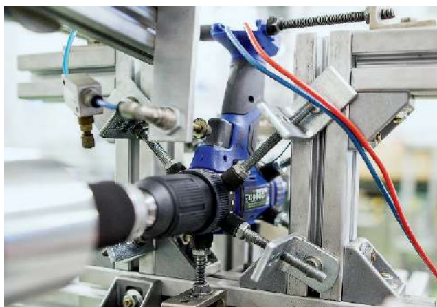
Auf dem Dauerprüfstand. Wie lange ein Gerät im harten Einsatz „überleben“ kann, muss es hier beweisen.
