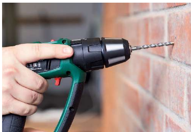
Im Handhabungstest. Der laut Bosch-Werbung „ergonomische“ Griff birgt das Risiko, das Gerät schief zu halten.
