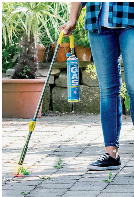
Gasflamme gegen Unkraut. Blätter müssen nicht verkoken. Sie sterben schon durch die Hitze.
