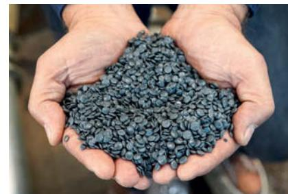
**FLAKES** aus geschredderter Ballenware werden über den EREMA-Prozess zu Kunststoff-Regranulat, daraus entsteht die schwarz eingefärbte Folie.
