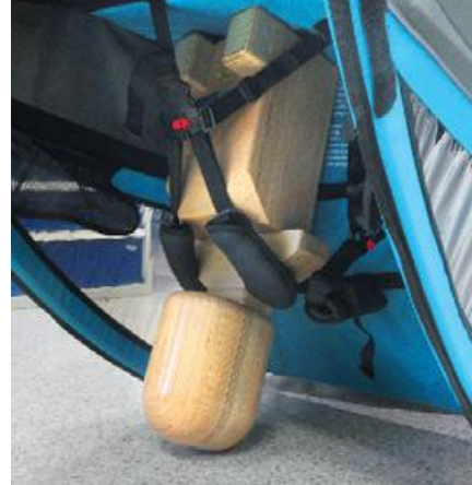
Überschlag. Im Propheten bleibt kein Platz zwischen Dummykopf und Boden.
