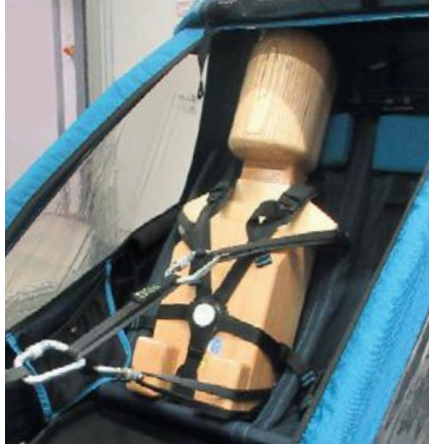
Zugprüfung. Eine Maschine zerrt am Prüfdummy, um die Gurte zu testen.
