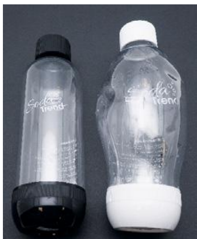
Unter Hochdruck. Im Belastungstest verformten sich einige Flaschen.
