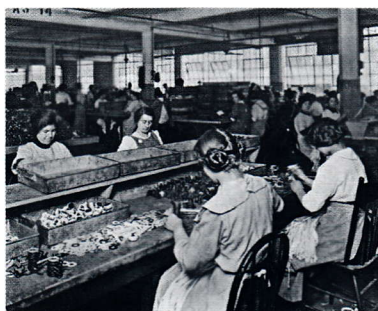
An langen Tischen setzen Frauen Teile der Zündung zusammen. Selbst ungelernte Kräfte beherrschen die wenigen Handgriffe schnell
