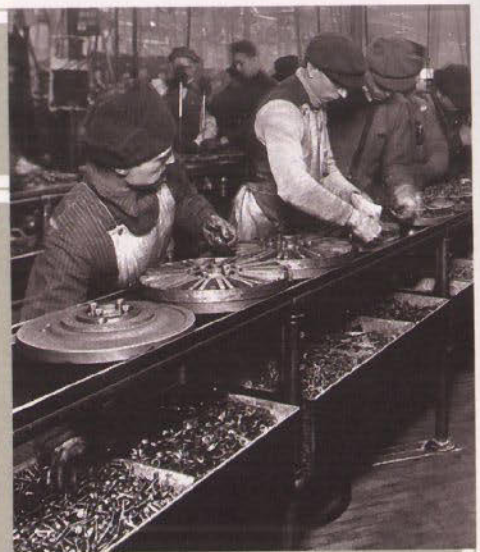
Montage von Motorschwungrädern am Laufband. Dieses Produktionsprinzip übernimmt Henry Ford von den Schlachthöfen
