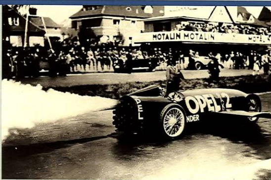
Eine Stahlpanzerplatte im Rücken trennt Fritz von Opel bei seiner Raketenfahrt am 23. Mai 1928 von den Pulverladungen des „Rak 2“
