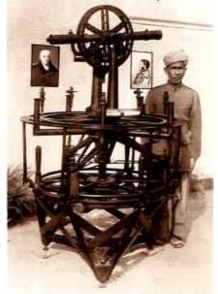
Mit Theodoliten ähnlich diesem, den der legendäre Landvermesser George Everest benutzt hat, ermitteln die Schlagintweits Höhe und Ausdehnung der Berge
