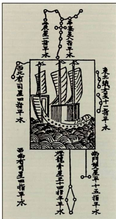
Nachts gleichen die Steuerleute ihren Kurs an Sternhöhen-Diagrammen ab: Dieses gibt an, dass der korrekte Kurs von Ceylon nach Sumatra anliegt, wenn im Norden (oben) der Polarstern ein Finger, im Nordosten (rechts) die Leier elf Finger hoch über dem Wasserspiegel steht und im Südosten (unten rechts) die beiden Sterne des Centaurus auf gleicher Höhe und 15 Finger über NN und im Süden (unten) das »Kreuz des Südens 14 1/2 Finger« hoch über dem Meeresspiegel strahlen
