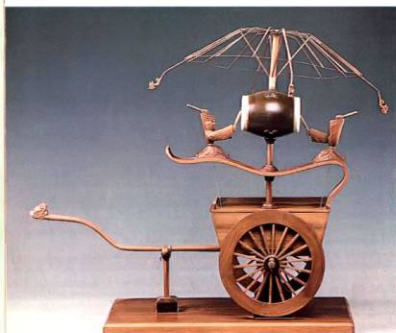
Rekonstruktion eines so genannten Odometer-Karrens, wie er um das Jahr 1100 im Gebrauch war: Ein Zahnradgetriebe lässt die Puppen jedesmal die Trommel schlagen, sobald ein li (rund 500 Meter) zurückgelegt ist
