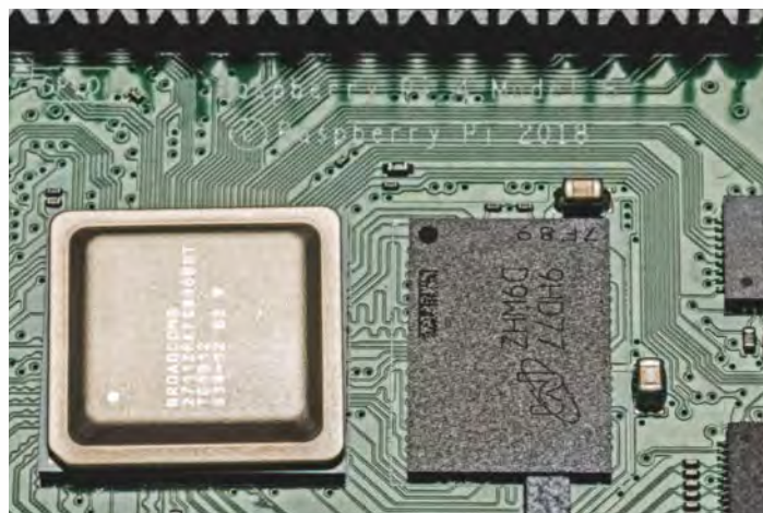
Die Platine des Raspberry Pi 4 hat wie seine Vorgänger die Fläche einer Kreditkarte. Trotz insgesamt sechs Kupferlagen ist der Platz für die vielen Leiterbahnen knapp.
