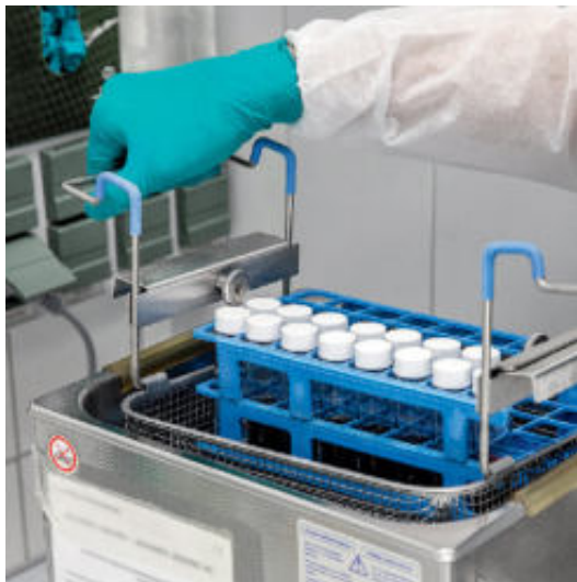
Schritt 4. Im Ultraschallbad wird die Lösung eine Stunde durchmischt, damit sich alle Stoffe gleichmäßig lösen.
