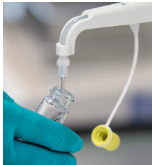
Schritt 3. Ein Lösungsmittel extrahiert die Schadstoffe aus dem Material. Referenz- substanzen dienen zur Kalibrierung.
