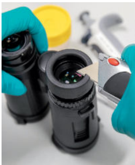
Schadstofftest: Schritt 1. Unsere Labo- ranten zerschneiden Augenmuscheln, Gehäuse und Tragegurte.
