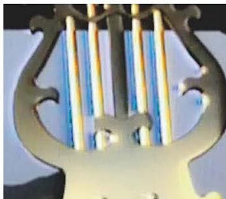
Bei zu starkem Overdrive schießt das Pixel über die Zielhelligkeit hinaus, was sich als Saum an bewegten Objektkanten äußert.
