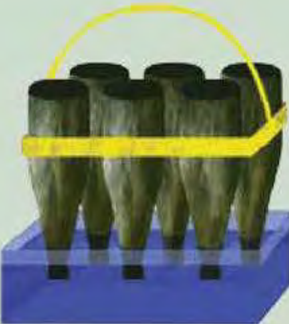
4. KÄLTEBAD Der Flaschenhals wird in einem Sole-Bad bei -20 °C bis -25 °C vereist
