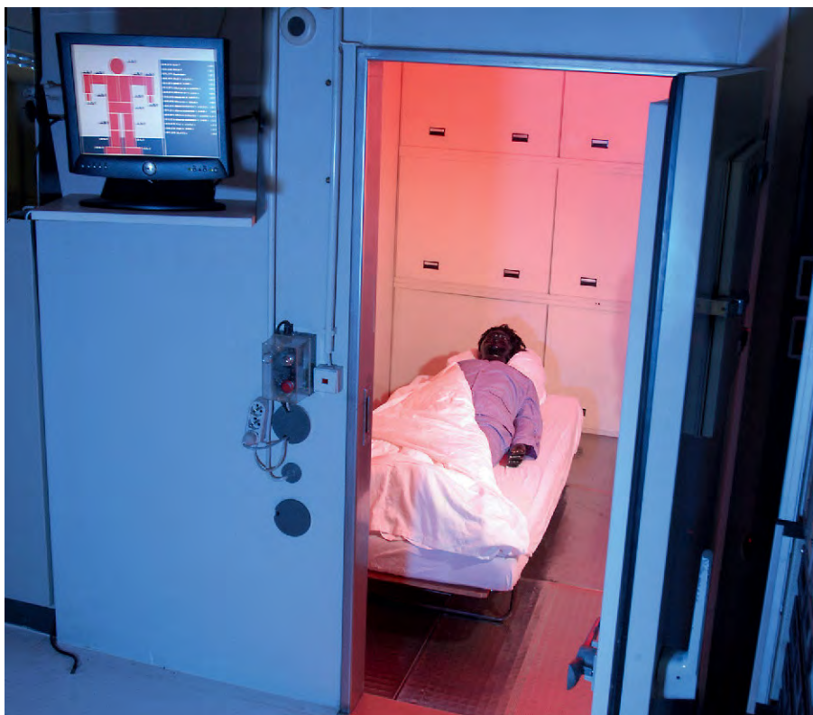
Laborschlaf. Die Testpuppe liegt sich schon mal warm. Unter Beobachtung schläft sie bei exakt 15 Grad Celsius und 50 Prozent relativer Luftfeuchtigkeit. Dabei messen wir Wärmeisolation und Atmungsaktivität der Decken.
