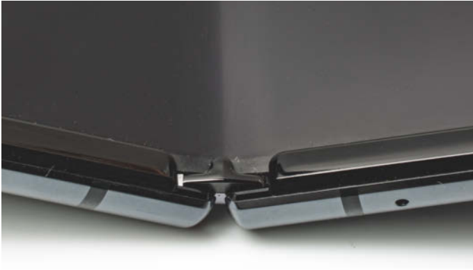
Kleine Kunststoffnasen an den Scharnieren sollen beim Fold 5G das Eindringen von Staubkörnern und anderen Partikeln verhindern.
