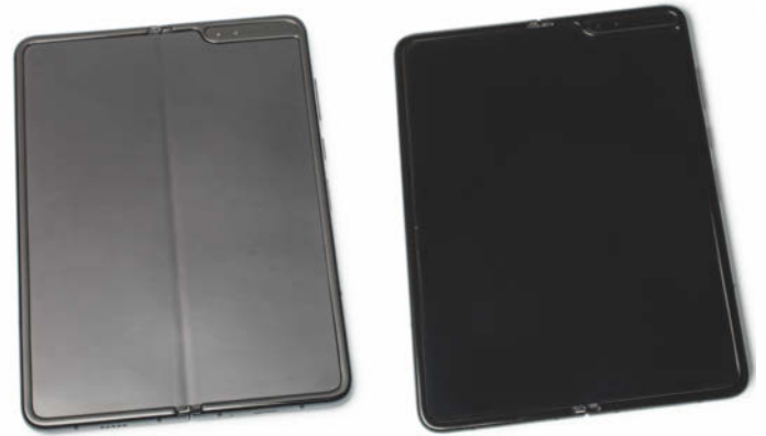
Die Falte in der Mitte des Displays erkennt man lediglich aus bestimmten Blickwinkeln (links). Schaut man frontal auf den Bildschirm, sieht man sie nicht.
