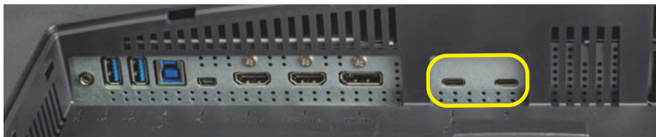
Alle Testkandidaten haben HDMI-Eingänge und DisplayPorts sowie eine USB-C-Buchse. Die zwei Typ-C-Buchsen bei Asus und BenQ nutzen Thunderbolt 3 mit 40 GBit/s.
