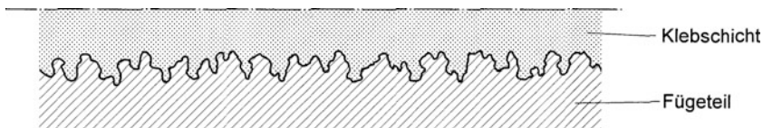
Abb. 6.1 Formschlüssige Verbindung von Klebschicht und Fügepart
