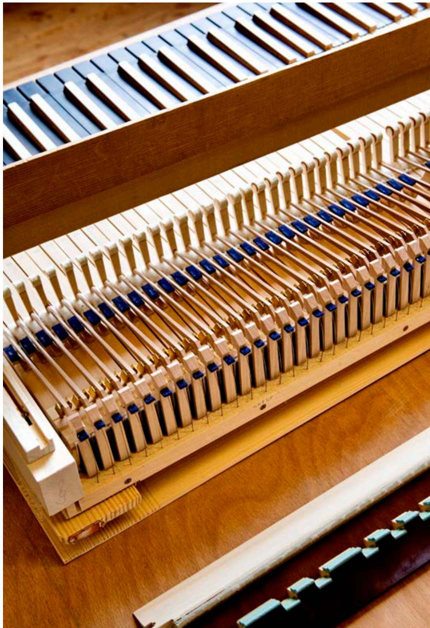
Bewährte Technik. Nikolaus Deckers beim Feinjustieren und Einbau der Tasten. Oben: das Innenleben vom Nachbau eines Instruments aus dem 18. Jahrhundert.
