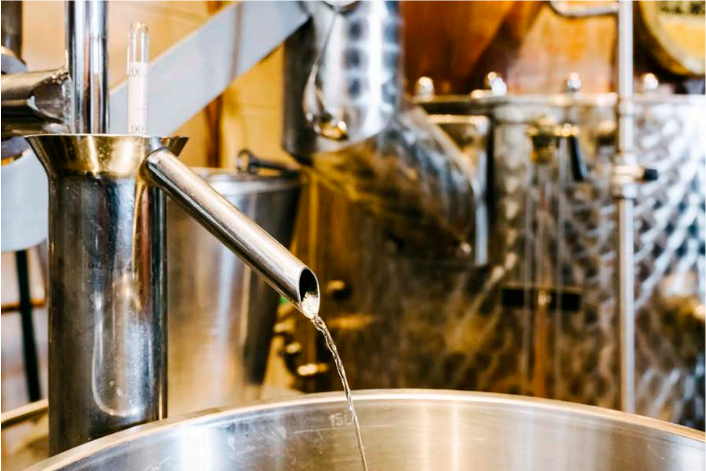
Hochprozentig. Langsam rinnt der Mittellauf, man nennt ihn das Herzstück des Schnapsbrennens, in den Behälter. Darüber tanzt das Messstäbchen hin und her, als wär's schon benebelt vom Alkohol, den es zu messen hat.
