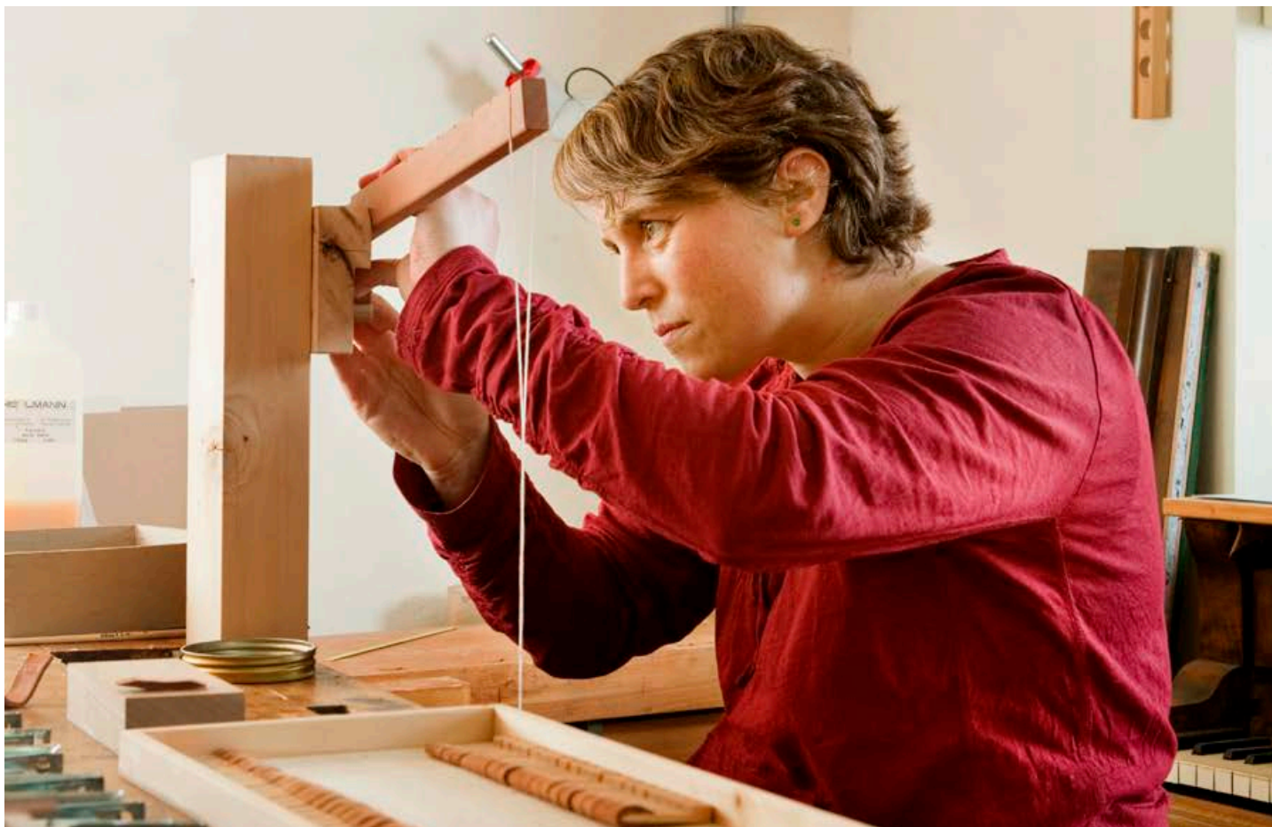
Kreativer Eigenbau. Mit dieser in der Clavierwerkstatt entwickelten Apparatur leimt Cembalobauerin Magdalena Sommer Leder auf die Köpfe der Klavierhämmer.
