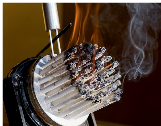
Qualmmaschine. Normzigaretten aus der Tabakforschung brennen kontrolliert ab.
