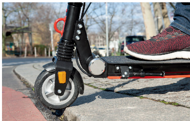
Holprig. Durch seine kleinen Räder rumpelt der Moovi sehr unsanft über Kanten und Pflastersteine.
