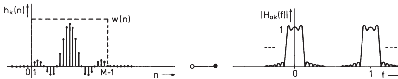
Abbildung 5.15. Impulsantwort und Übertragungsfunktion des kausalen, linearphasigen, diskreten Tiefpasses bei rechteckförmiger Fensterfunktion w(n)
