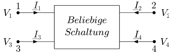
Abbildung 12.2.: Schematische Darstellung eines Vierpols
