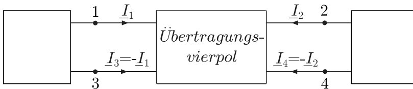
Abbildung 12.3.: Schematische Darstellung einer Zweitorschaltung
