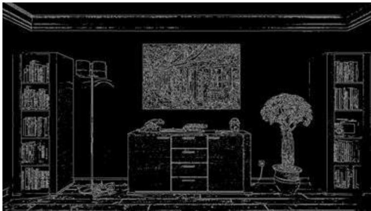
Abb. 5.2: Bild nach Edge Detection
