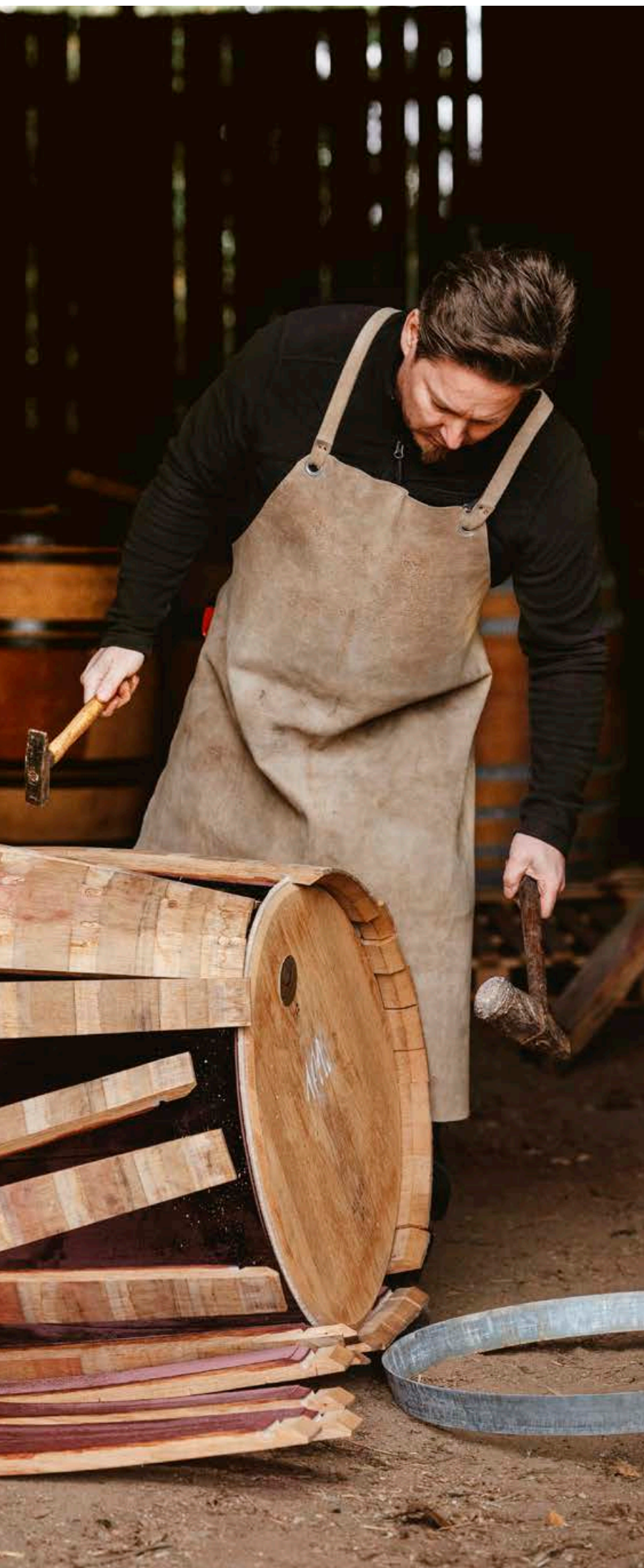
Feinarbeit. Mit Hammer und Drahtbürste werden die alten Fassdauben vom Weinstein befreit. Ganz am Schluss ölt sie Bernd Hamal vorsichtig ein.
