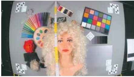
Das Sichtfeld der Kogolike-Webcam ist zu groß, das Bild stark kissenförmig verzerrt.
