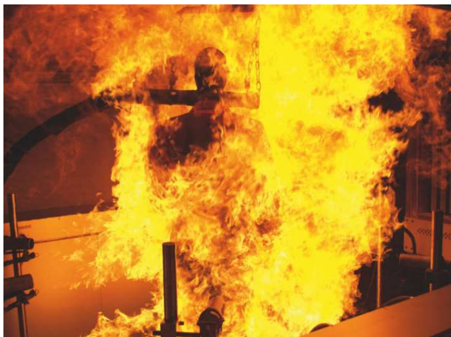
Spezielle Dummies in der Klimakammer messen die Temperatur auf der Hautoberfläche, auch wenn es beim Test von Feuerwehrsutzhkleidung in einem Flammenmeer mal ungemütlich wird.
